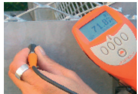
Mätning av zinksiktets tjocklek.
